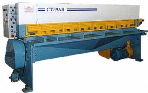
Ножницы гильотинные с наклонным ножом СТД9АН предназначены для резки листового материала толщиной до 4 или 6 мм (в зависимости от модели), с временным сопротивлением  $\sigma_b=500$  Мпа (50 кгс/мм).
