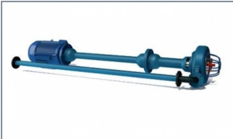
НЦИ-Ф надежный высокопроизводительный агрегат, обеспечивающий подачу перекачиваемой среды в ёмкости по трубопроводам или в очистительные устройства. Насос устанавливается на опорных стойках, что позволяет ему работать в вертикальном и наклонном положениях.
