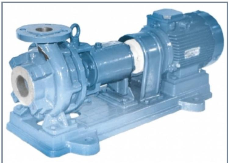
Насосы центробежные типа К 50-32-125, К 65-50-160, К 80-50-200 предназначены для перекачивания воды, а также других невзрывоопасных жидкостей, сходных с водой по вязкости и химической активности, содержащих твердые включения в количестве не более 0,1 % по объему и размерам частиц не более 0,2 мм. Температура перекачиваемой жидкости от 0 до +85°C.
